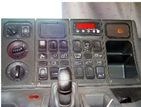
El equipo instalado en el interior de la cabina es de fácil manejo, ya que mediante dos teclas es posible conocer el peso de la cabeza tractora, del remolque el peso neto, la estiba y el total. Los tramos de indicación son de 10 kg, y para conocer su manejo no es necesario leer un grueso manual.
